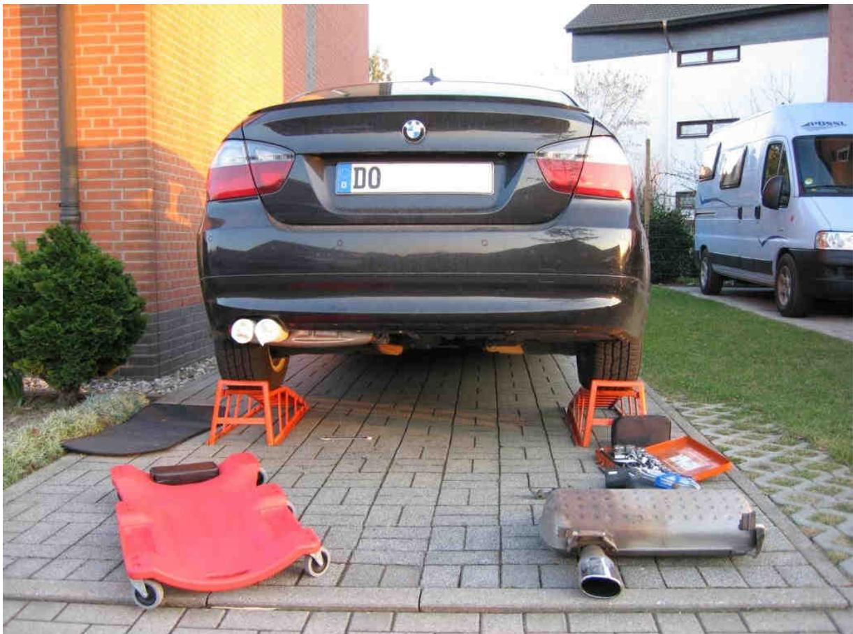
Der alte ESD muss als erstes abgeschraubt werden an den markierten Stellen befinden sich 2 Schrauben.
