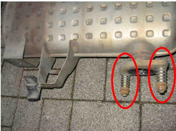
Nun kann man den ESD vom MSD abziehen dort wo man die beiden Schrauben gelöst hat. Das Rohr vom MSD ist etwas länger und steckt zum besseren Halt in ESD.
